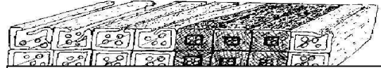
Vorbeizen: gerbstoffarme Hölzer werden in den Zellhohlräumen gerbstoffreich wie Eiche und Nussbaum
