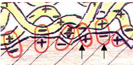
Klebrücken zwischen Leim u. Holz
